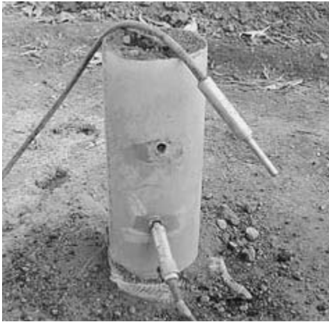
第1図 パイプ試験に用いた塩化ビニルパイプと温度センサー
